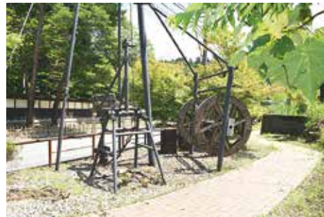
写真2 C39号綱式機械掘り石油井戸 操業期間：M42（1909）年～H8（1996）年
