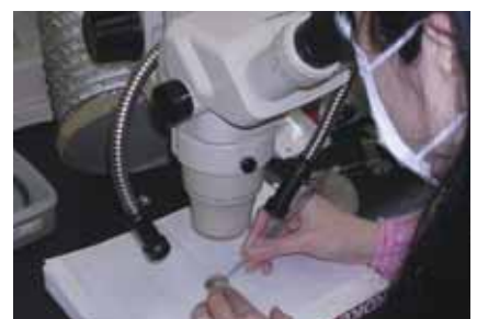
銭貨表面のさびを実体顕微鏡下で除去
