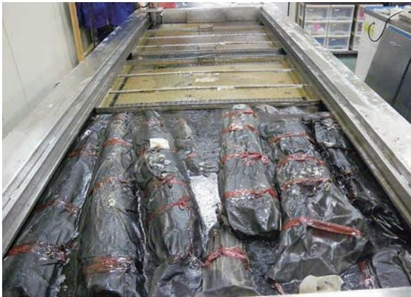
● 大型含浸装置での含浸状況
