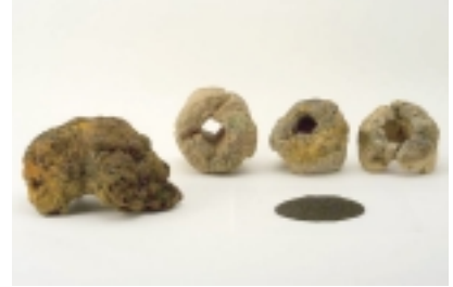
左：鉄滓 右奥：羽口 右手前：砂鉄
