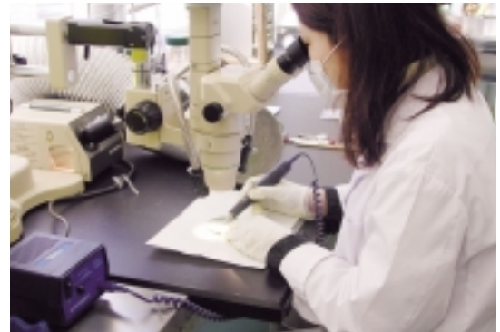
実体顕微鏡の下で遺物を傷つけないようにグラインダーで注意深くサビを落している様子
