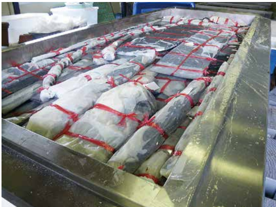
大型含浸装置での含浸状況
